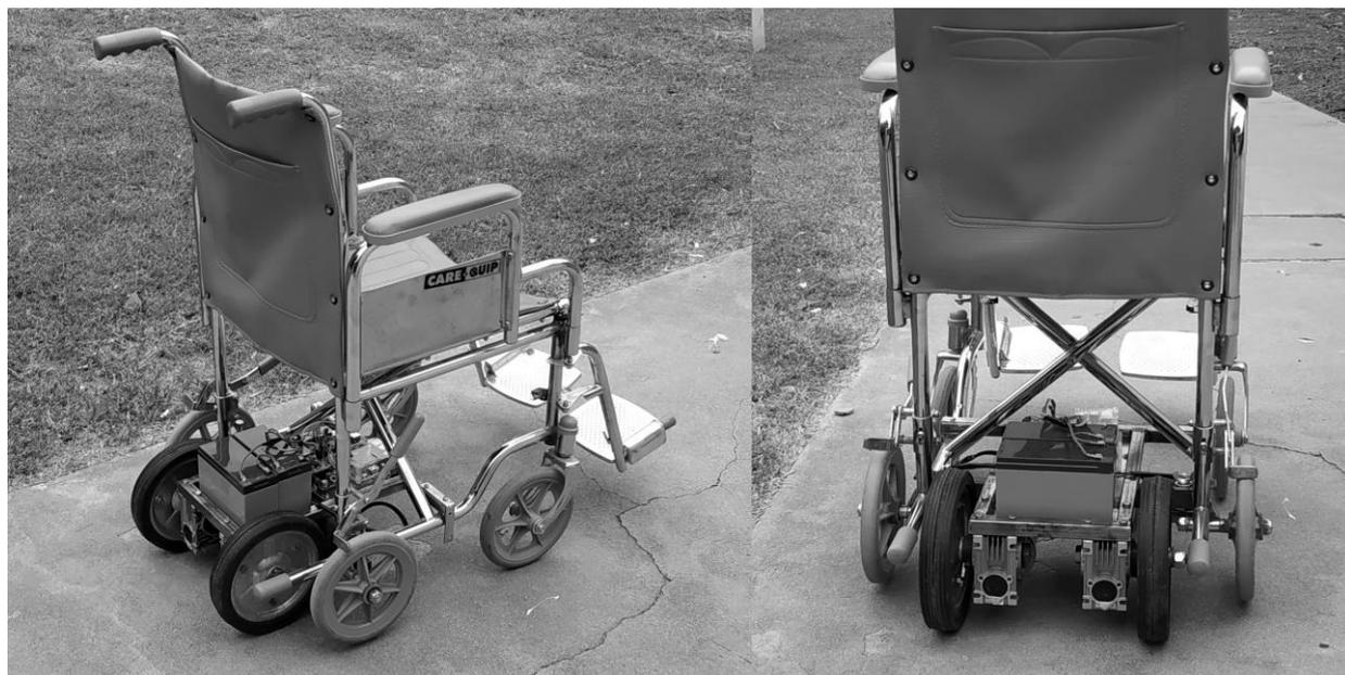
Figura 2: Plataforma ensamblada en silla de ruedas
